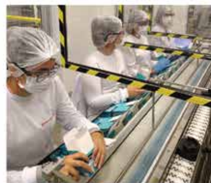
Barreiras físicas implementadas nos postos de trabalho
